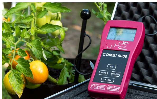
Gleichzeitige Messung von Salzgehalt, Bodenfeuchte und -temperatur mit Multi-Sonde
