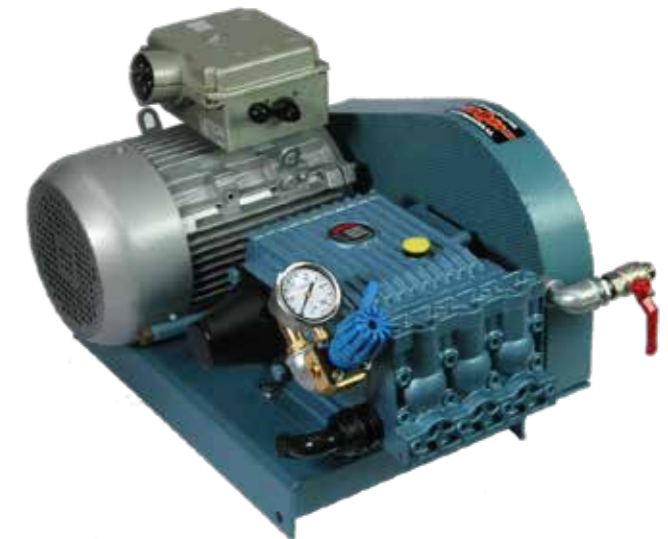
Pumpe mit Elektromotor
