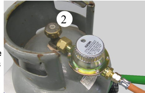
Abb. 5-1: Ventil der Gasflasche
