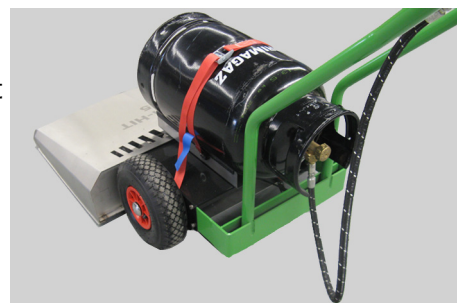
Abb. 3-9: Position der Gasflasche
