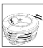
fig. 8 - inserire il tubo flessibile
