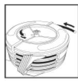
fig. 8 - mettre le nouveau tuyau en place
