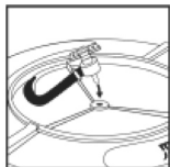
fig. 10 - instale el pivote
