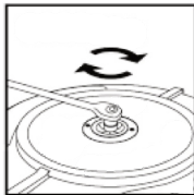
fig. 2 - tournez dans le sens des aiguilles d'une montre. 1 clic correspond à 90°
